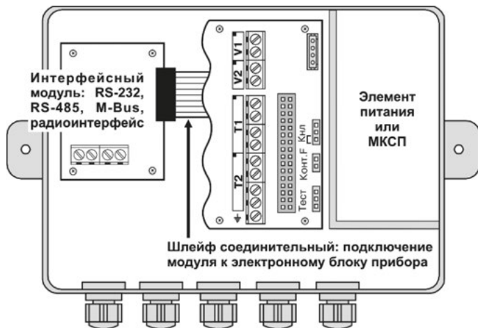
Рисунок Б.4 – Внешний вид монтажного отсека вычислителя KARAT-306 с установленным интерфейсным модулем
