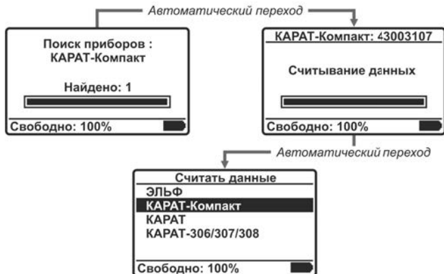
Рисунок 4.7 – Алгоритм работы пульта при получении данных с приборов типа КАРАТ-Компакт
